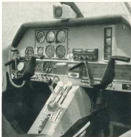
Sur cette vue de la cabine du WA-52, les lignes fonctionnelles des volants à cornes sont mises en évidence. Comme sur le WA-51, la console centrale groupe les commandes moteur et hélice.
