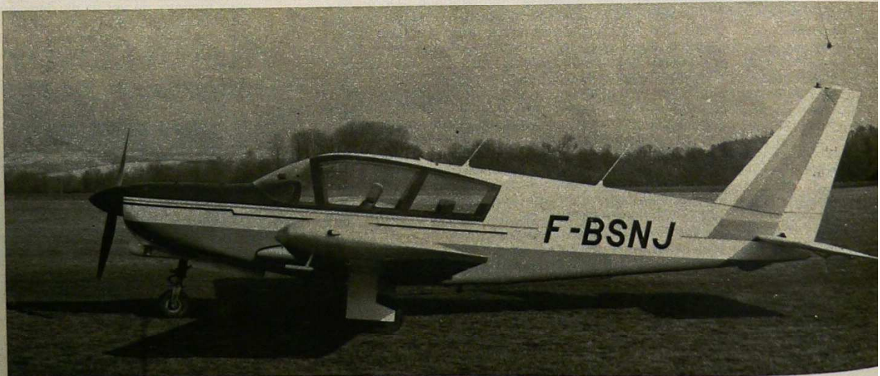
Cette vue de profil met en évidence la netteté des lignes du « Guépard ». Il dispose d'une cabine quadriplace suffisamment spacieuse pour que l'avion reçoive ultérieurement deux places en plus...
