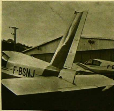
L'empennage du "Guépard" et son stabilisateur monobloc doté de deux anti-tabs. La gouverne de direction est maintenant équipée d'un trim tab venant remplacer le dispositif décrit dans le texte.
